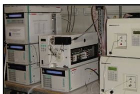
HPLC : 2 unités de criblage et 1 chaîne dédiée au semi-préparatif
